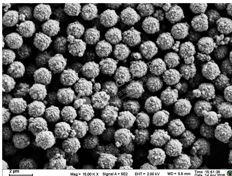
图 1.MagBeads® 1 μm 硅羟基磁珠 SEM 图
