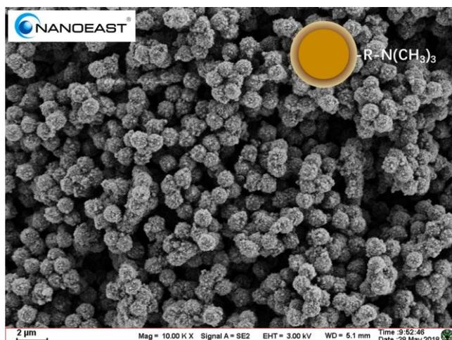
图 1. MagBeads® 1 μm MPSE-SAX 固相萃取磁珠 SEM 照片
