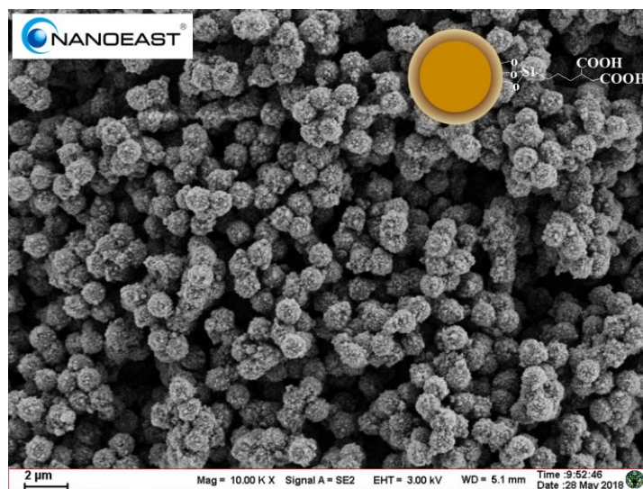
图 1. MagBeads® 1 µm MPSE-WCX 固相萃取磁珠 SEM 照片
