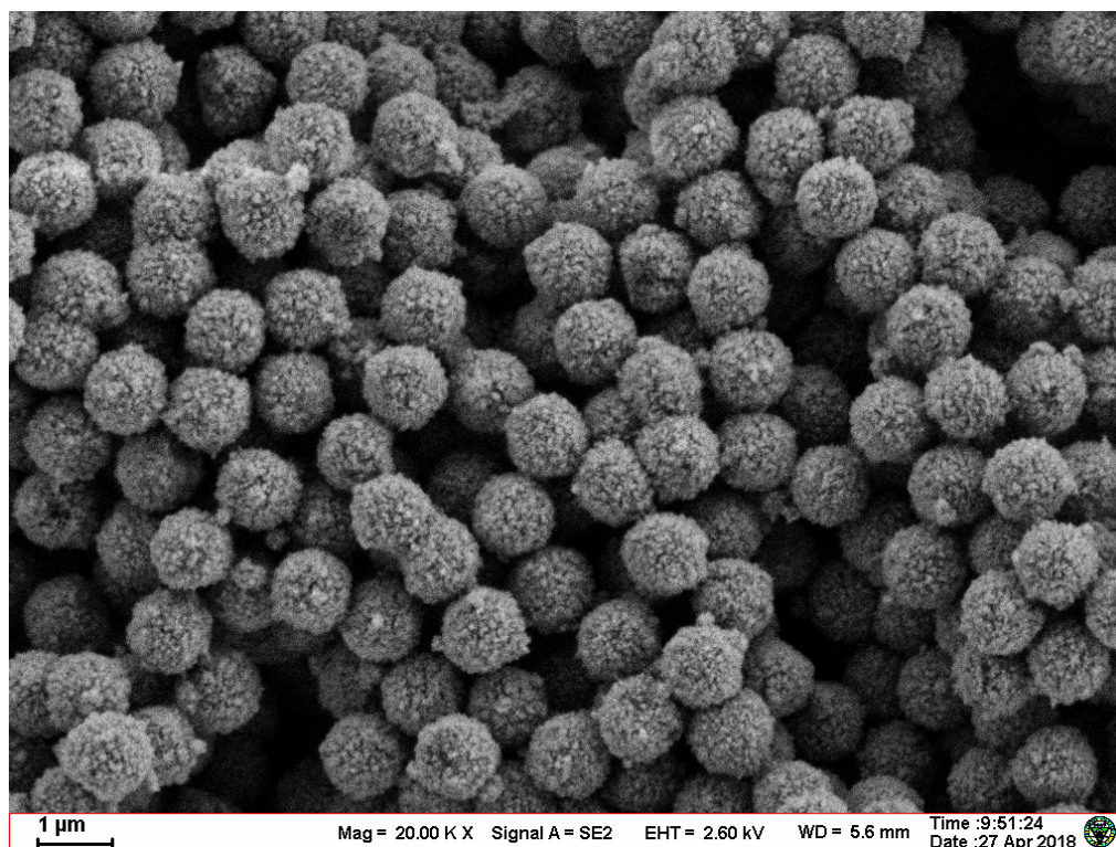
图 1. MagBeads® 1 μm 核酸纯化/分选磁珠 SEM 图
