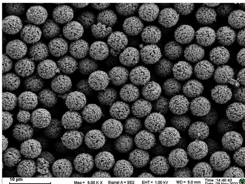
图 1. MagBeads™ 5 μm 链霉亲和素磁珠 SEM 照片
